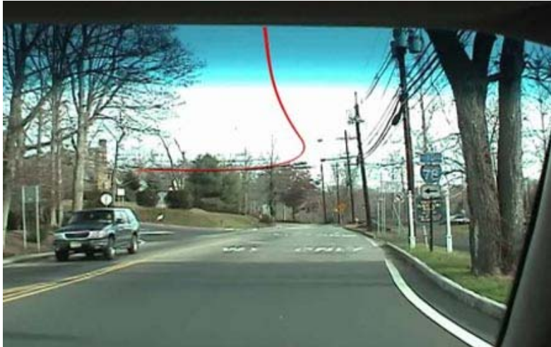
Figura 12: Virtual Cable, proyección de la ruta en el parabrisas
