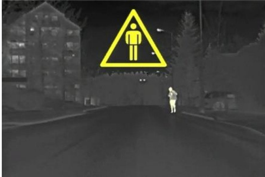
Figura 11: Sistema de detección nocturno de personas de BMW
