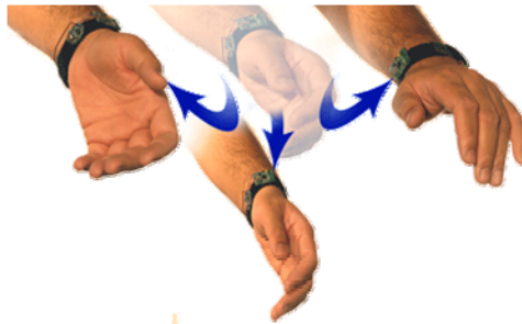
Fig. 5: Reachmedia: Brazalete que obtiene input de gestos (mediante acelerómetros) y dispone de altavoz [11]
