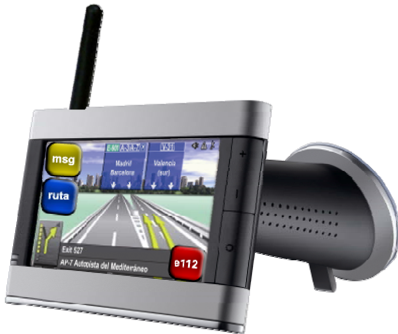
Fig. 18: Interfaz de usuario para el tipo de usuario Camionero y vista del dispositivo hardware
